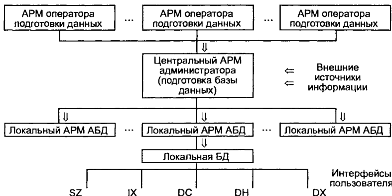
Рис. 4.3. Взаимодействие программных компонент ЮРИУС в процессе создания и использования БД
